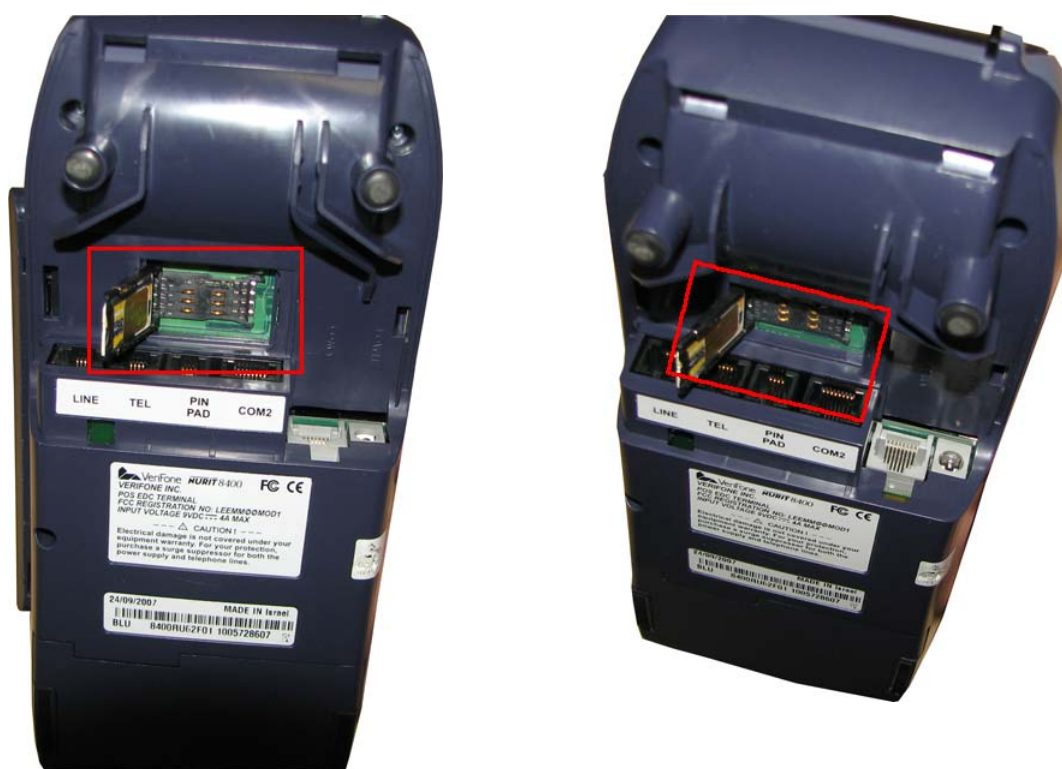
Рис. 3. Расположение разъема для сим-карт в терминалах Nurit 8400
